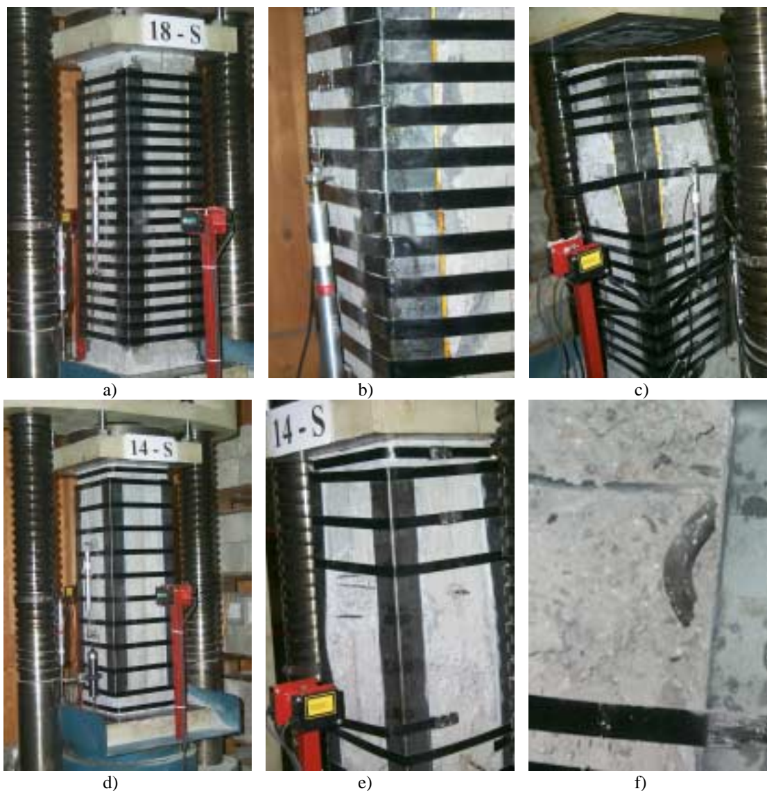
Fig. 5.2 Tipiche rotture riscontrate nelle colonne rinforzate con CAM (a-b-c=CAM40; d-e=CAM80; f=barra d'angolo instabilizzata nell'unica direzione lasciata libera dall'angolare)
