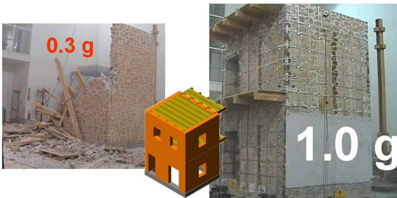
**Figura 13: Sistema CAM – comparazione esiti dopo prova su tavola vibrante presso il Laboratorio ENEA (Casaccia – RM)**
