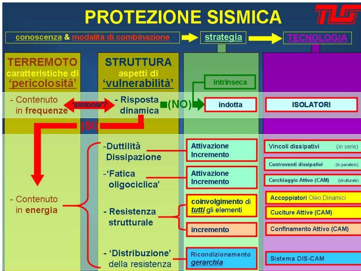
Figura 1: quadro sinottico del processo di inquadramento della Protezione Sismica delle strutture.
