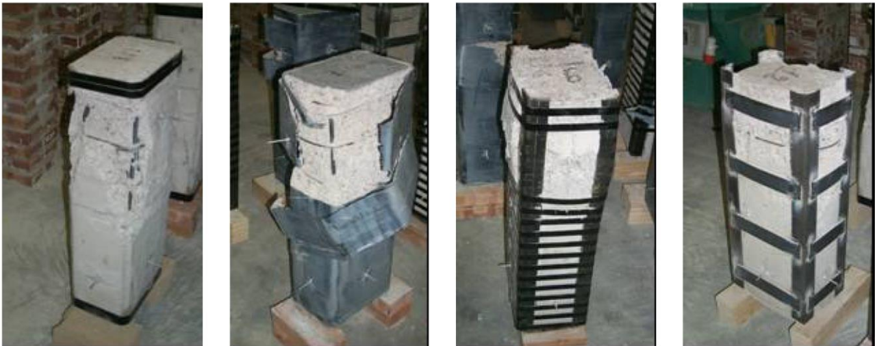
Provini a fine prova
