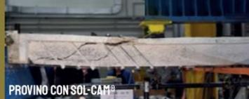
Travetto "AS BUILT" e Travetto rinforzato con SOL-CAM® volti a definire le formulazioni per il **calcolo della resistenza a taglio**.
