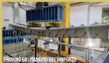
Confronto tra provino "AS BUILT" e rinforzi SOL-CAM® a 1, 3 e 5 coppie di nastri in campata con **incrementi** delle prestazioni del travetto (a taglio e a flessione) **superiori al 300%**.
