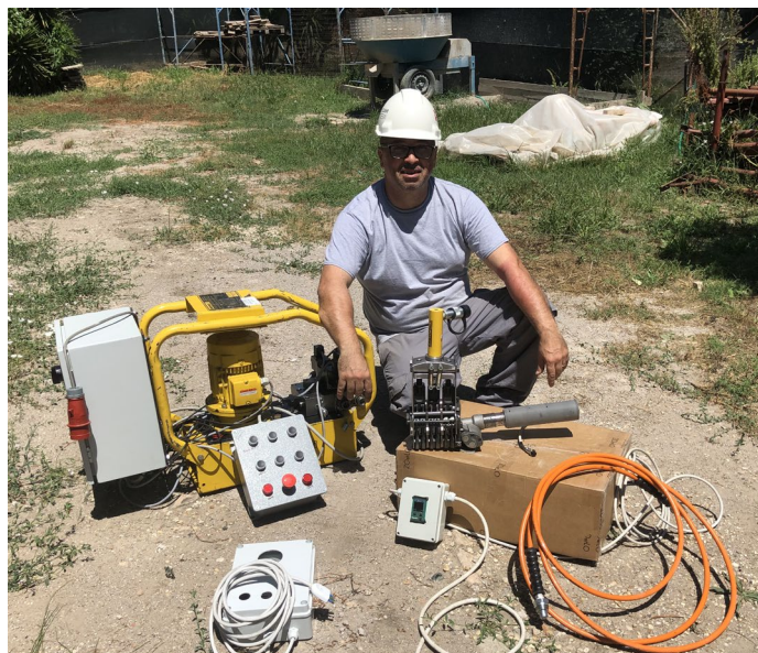
fig. 3 - Prototipo di attrezzature per la posa in opera della nuova giunzione
